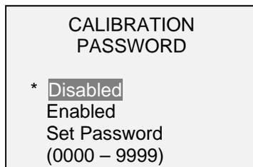
Para establecer la contraseña, seleccione **Enabled** (Habilitado) , y, a continuación, **Set Password** (Establecer contraseña).. Utilice las teclas y para incrementar y disminuir los valores, de 0 a 9999. Cuando haya seleccionado el valor deseado, presione **ENTER** (INTRO), y, a continuación, **ESC** para salir del submenú.
