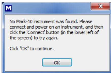
Dies Nachricht erscheint, nachdem die Software geöffnet wurde und kein Messgerät erkannt wurde. Vergewissern Sie sich, dass das Messgerät angeschlossen, eingeschaltet und sachgemäß konfiguriert ist.
