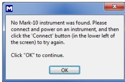
Wenn das Messgerät ordnungsgemäß angeschlossen und konfiguriert ist, aber die Nachricht immer noch erscheint, können Sie die COM Port-Verbindung manuell konfigurieren. Informationen zur Kommunikation können Sie dem nachstehenden Flussdiagramm und den folgenden Abschnitten entnehmen.
