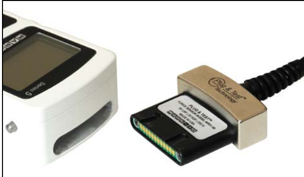
Abb. 3.1 Korrekte Ausrichtung des Plug & Test™-Verbindungssteckers.
